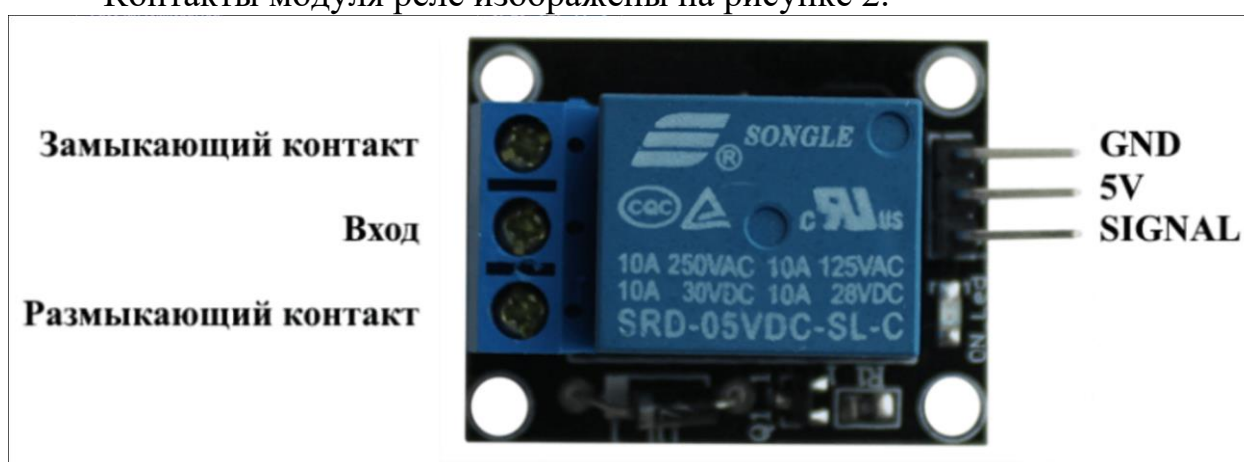
Рисунок 2 – Контакты модуля реле
